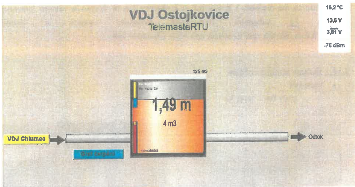
Obrázek 11 Dálkový přenos z VDJ Ostojkovice
