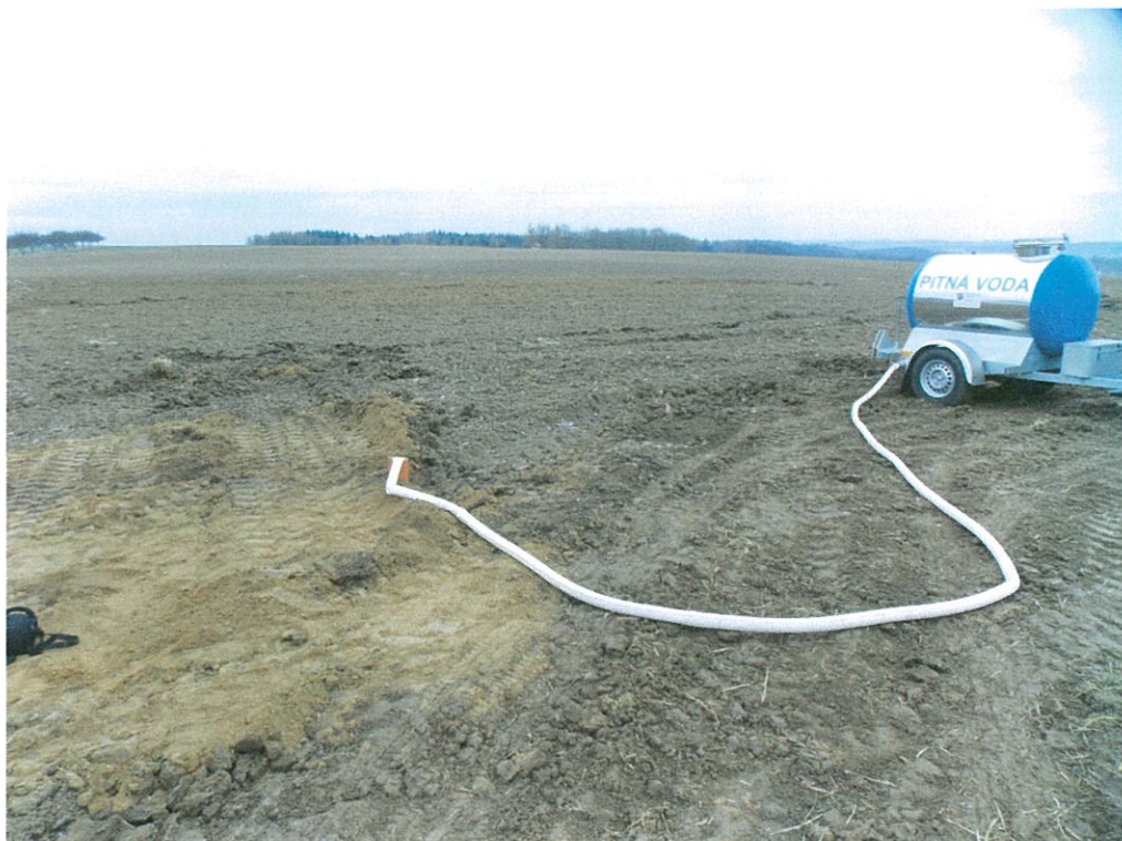
Foto č. 1: Nálevková zkouška na sondě KS-4
